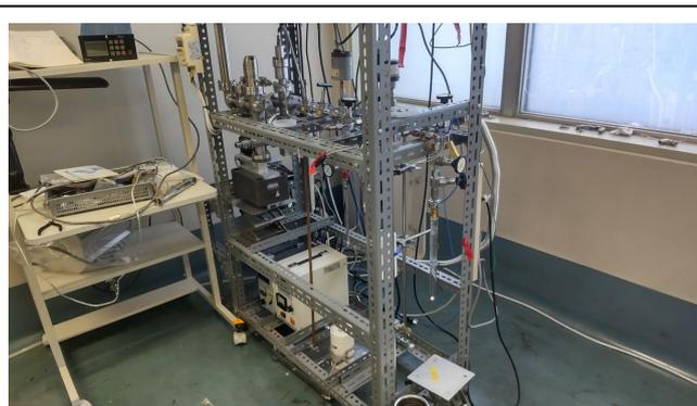
図1 トリチウム暴露装置
