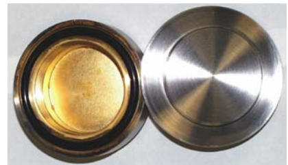
図IV-2-13 トリチウム水測定用金属製バイアル
