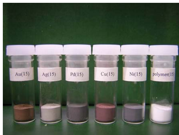
図IV-3-17 Au、Ag、Pd、Cu、Ni を修飾した PMMA ポリマーと未修飾ポリマー (15 μm) の外観写真
